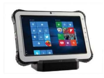
Die Dockingstation lädt das Tablet und den Zusatzakku gleichzeitig.
